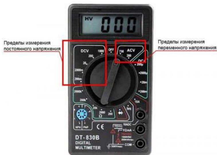
*Рис 32. Измерения напряжения в цепи*
