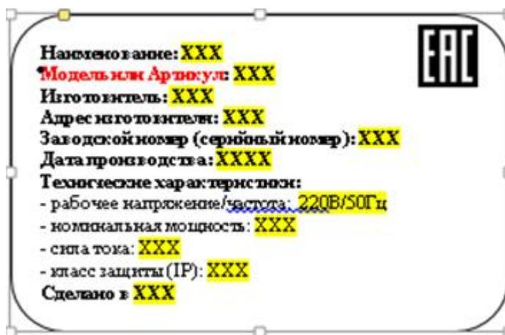
*Рис 49. Маркировка оборудования*
