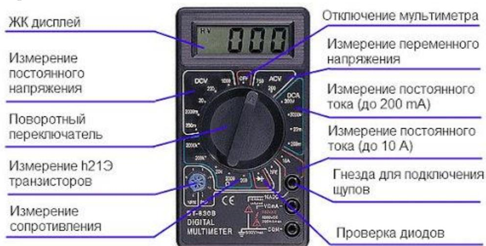
*Рис 79. Мультиметр*
