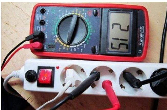
*Рис 34. Измерения мультиметром 220В*
